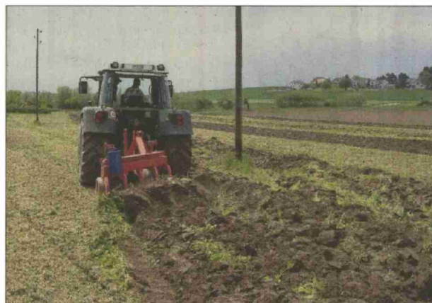
Der Stoppelhobel funktioniert gut zur flachen Einarbeitung, besonders im schweren Boden. (Bild FiBL)
