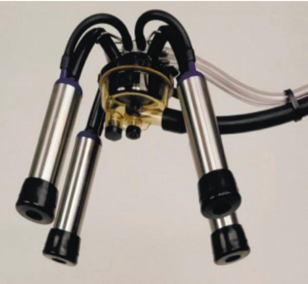
Рис. 5. Контроль чистоти, якості та періодичності заміни гуми доїльних апаратів
